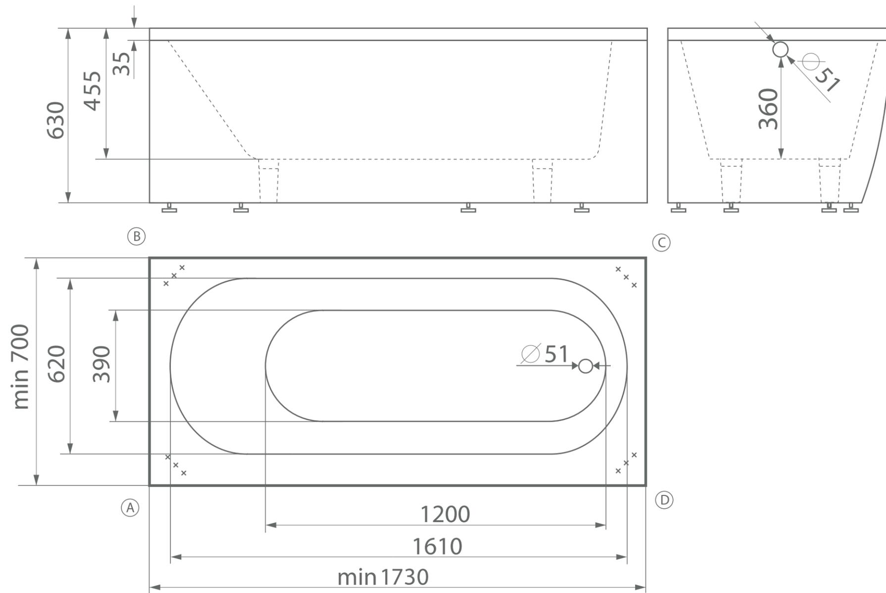
A, B, C, D - место врезки дополнительного оборудования.
