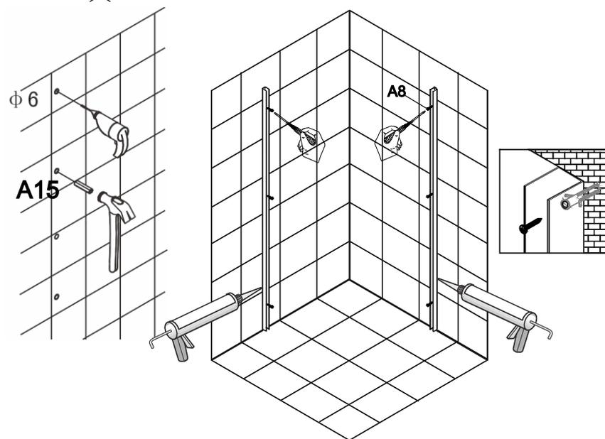
\*\*\*Нанесите герметик на тыльную часть профиля перед установкой на стену помещения.
