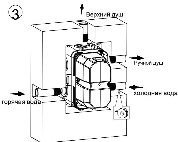
3. Закрепите скрытый корпус (1), затем затяните винты. Откройте клапаны для проверки на утечку.
