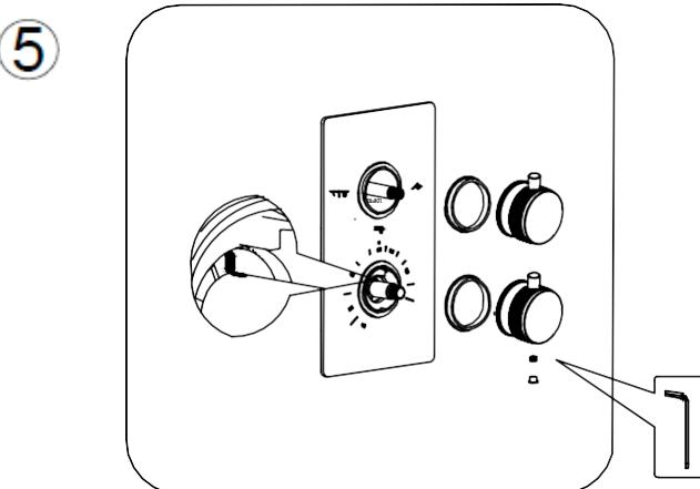
5. Установите лицевую панель (2) на скрытый корпус (1) в правильное положение. Закрепите ручку управления (4) и ручку переключения режимов (3) с помощью крепежного комплекта.
