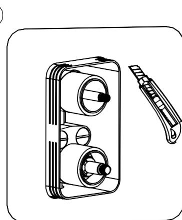
4. Снимите защитный кожух, разрежьте внешний пластиковый корпус канцелярским ножом, после чего можно устанавливать панель.
