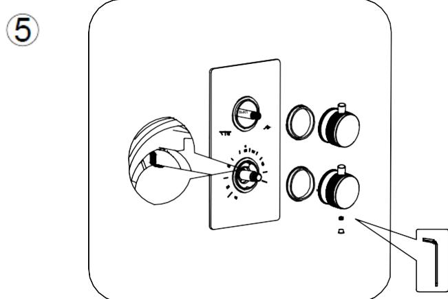
5. Установите лицевую панель (2) на скрытый корпус (1) в правильное положение. Закрепите ручку управления (4) и ручку переключения режимов (3) с помощью крепежного комплекта.
