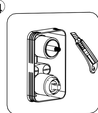
4. Снимите защитный кожух, разрежьте внешний пластиковый корпус канцелярским ножом, после чего можно устанавливать панель.
