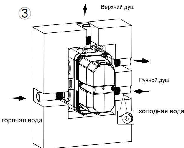
3. Закрепите скрытый корпус (1), затем затяните винты. Откройте клапаны для проверки на утечки.
