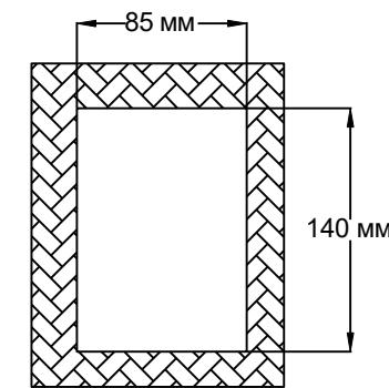
1. Перед установкой подготовьте отверстие в стене глубиной 65–85 мм, длиной и шириной 130×190 мм.
