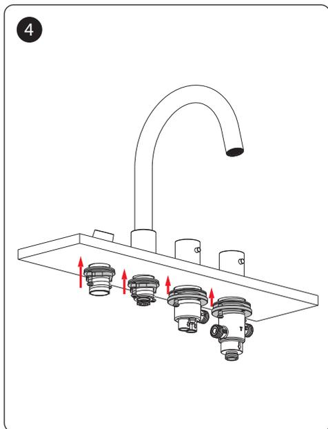
Вставьте держатель ручного душа и излив в отверстие. Наденьте снизу резиновую шайбу, металлическую шайбу и гайку с фиксирующими винтами на хвостовик резьбы. Затяните гайки и зафиксируйте их винтами.
