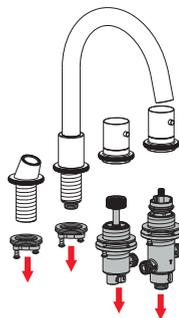
Извлеките гайки с фиксирующими винтами, металлические и резиновые шайбы из держателя для ручного душа и комплекта для разлива.
