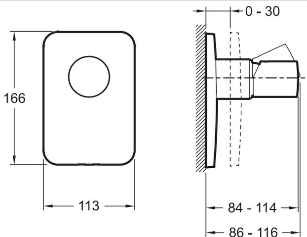
Спецификация продукта: Встраиваемый смеситель на 1 выход, лицевая панель TooBi. E98707. Коллекция: TOOBI. Вес: 1,9 кг. Комплект для установки Modulo 98699D.
