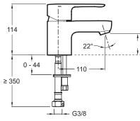
Спецификация продукта: Однорычажный смеситель для раковины, без донного клапана. E16027-4ND. Коллекция: JULY. Вес: 1,2 кг. Тип установки: 1 отверстие. Расход воды: 10 л/мин при давлении 3 бар. Механизм: Последовательный керамический каргридж.
