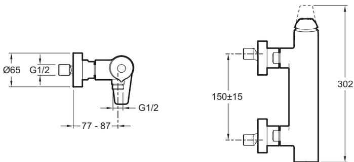
Спецификация продукта: Настенный смеситель для душа. E97368. Коллекция: AVID. Вес: 3,5 кг. Тип установки: Крепление к стене. Нормы и правила: ACS : 14 ACCLY 511. Расход воды: 27 л/мин при давлении 3 бар. Подключение: С соединителями и настенными крепежами. Механизм: Керамический картридж. Разметка отверстий: 150 мм +/- 15. Обратный клапан на выходе для душа.
