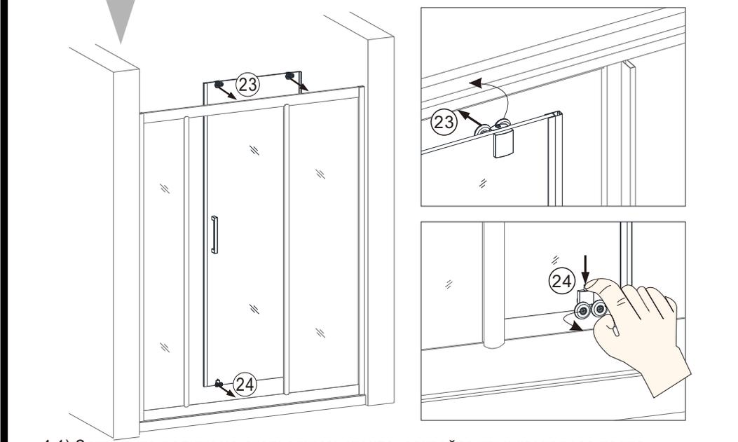
4.1) Закрепите ролики на скользящем стекле, закройте крышку колеса после регулировки.
