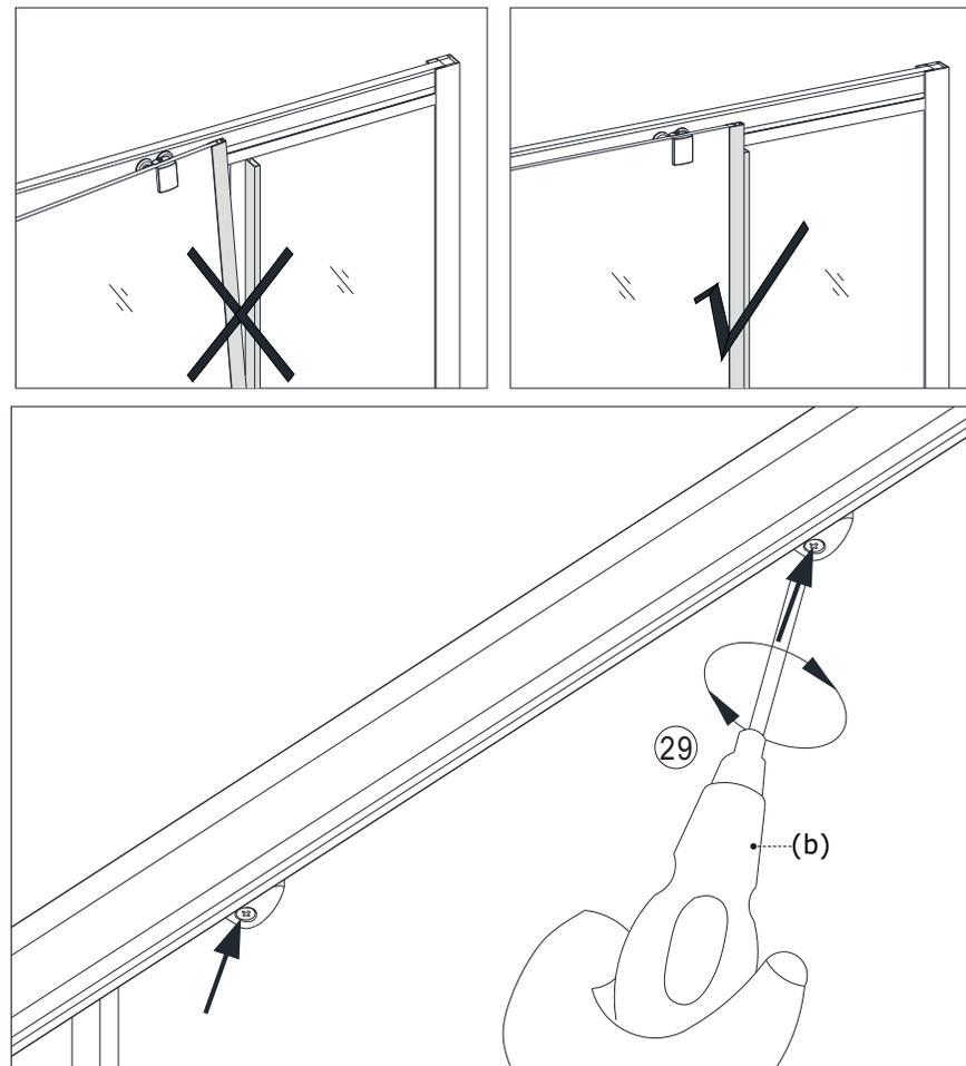
5.1) Пожалуйста, установите ролики раздвижной двери в алюминиевую направляющую. Если середина 2-х раздвижных дверей находится не по вертикали или, если после установки магнитного уплотнителя между 2-я дверьми имеется зазор, следует отрегулировать винт на роликах с помощью отвертки, чтобы 2-е раздвижные двери плотно прилегали друг к другу
