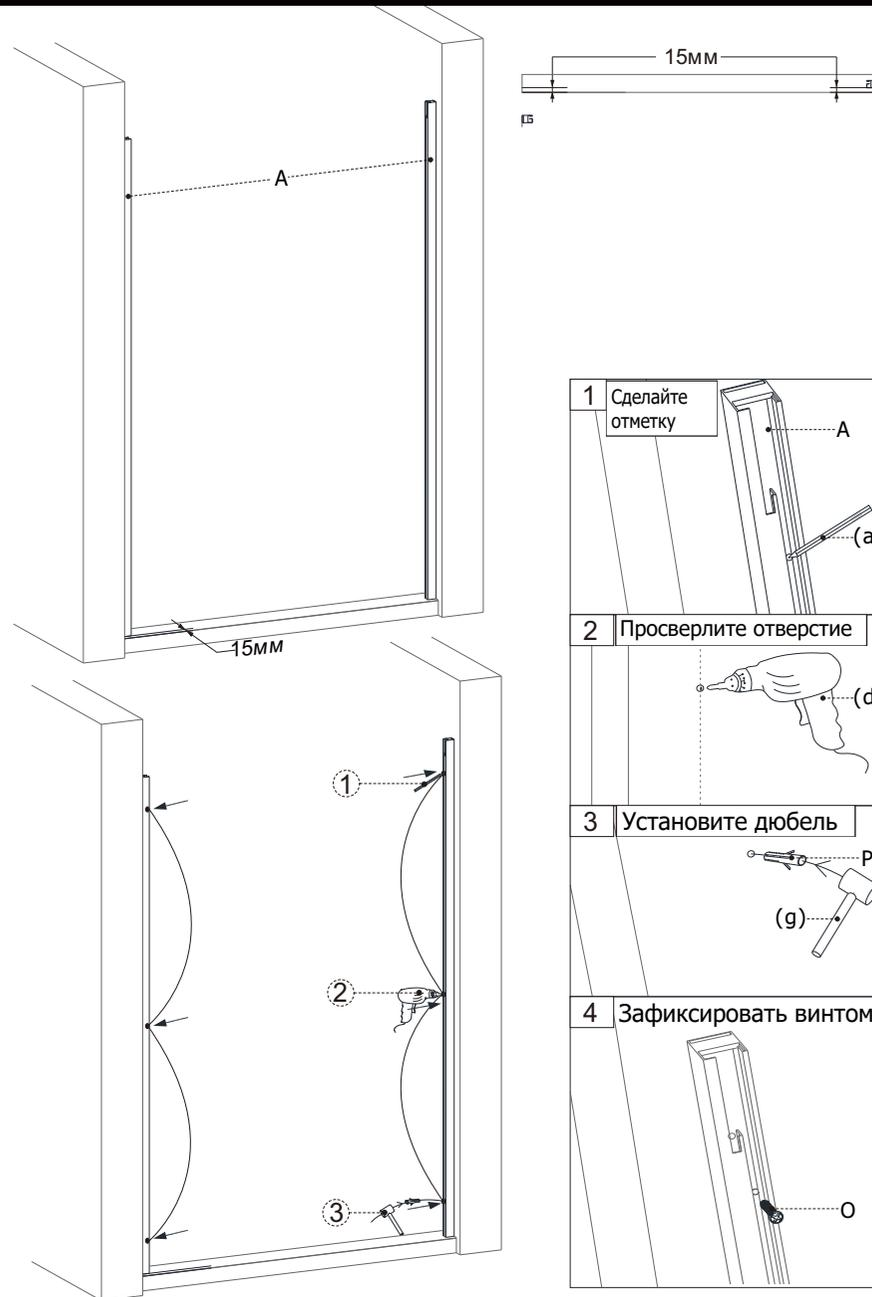
2.1) Отметьте 6 точек; Переместите душевой угол и просверлите отверстия, затем установите пластиковые дюбеля. Закрепите профиль на стене с помощью винта.
