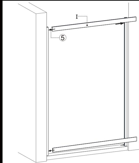
После установки одной боковой рамы, вставьте направляющие в раму, прежде чем закрепить другую сторону рамы.
