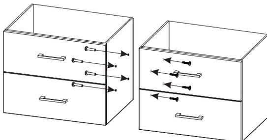
3. Присоединить стяжки пластмассовые на имеющиеся отверстия к боковым стенкам тумб, саморезами 3.5x16.
