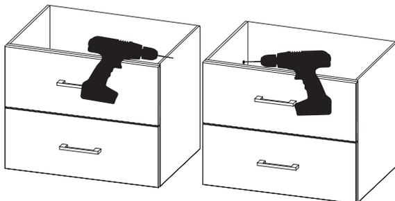
2. В просверленные отверстия вставить стяжки межсекционные. В одну тумбу идет стяжка 6x30, а в другую 6x14.
